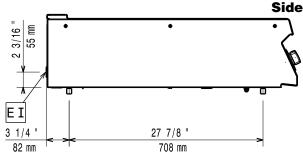
El = Electrical inlet (power) EQ = Equipotential screw
