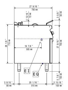
**EI** = Electrical inlet (power) Equipotential screw
