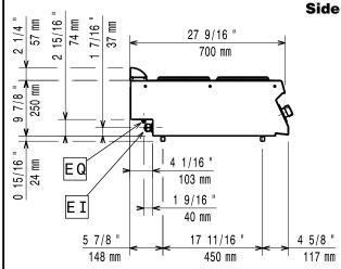
**EI** = Electrical inlet (power) Equipotential screw
