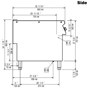
Electrical inlet (power) Equipotential screw
