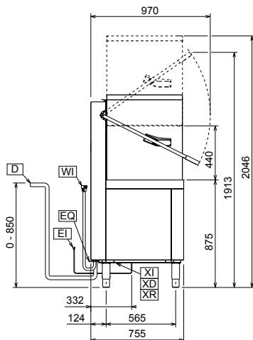
**CWI1** = Raccordement eau froide      **XI** = Raccordement produits chimiques
