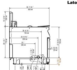
El = Connessione elettrica Vite Equipotenziale G = Connessione gas
