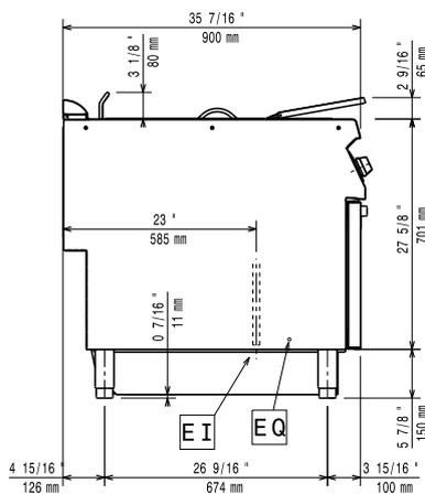
EI = Conexión eléctrica (energía)
