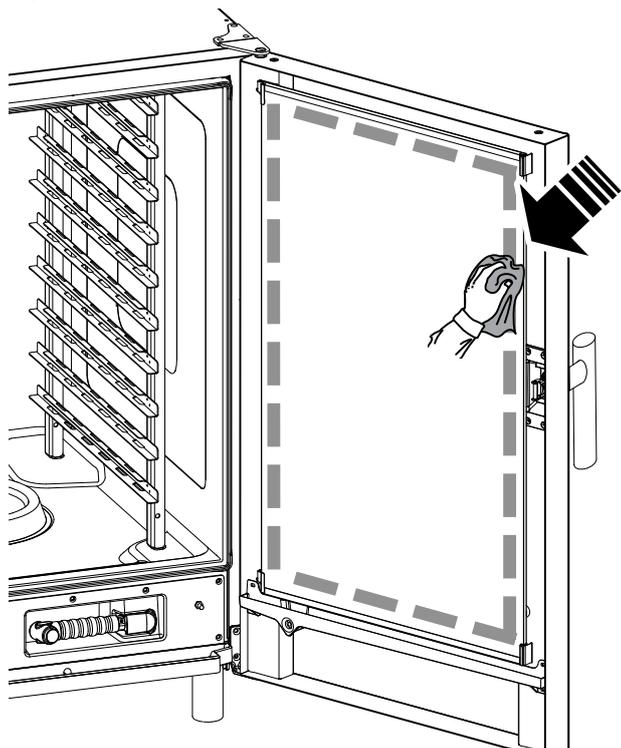
2. Con la puerta abierta, presione las sujeciones superior e inferior como se muestra en la figura para llegar al intersticio entre el cristal interior y el exterior.
