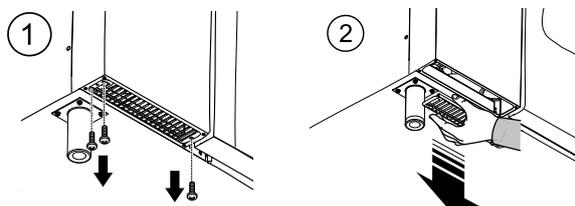
2. Retirer le filtre et le dégraisser en le lavant avec un produit vaisselle ;
