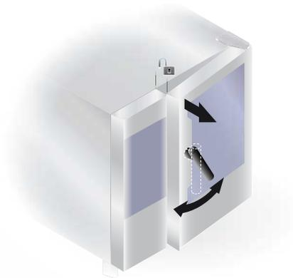
1. Tourner la poignée de porte à fond dans le sens horaire ou dans le sens anti-horaire pour ouvrir complètement la porte du four. S'il est en cours, le cycle de cuisson est interrompu.
