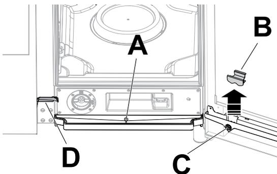
3. Utiliser régulièrement la brosse à poils en nylon (fourni avec l'appareil, en fonction du modèle) pour nettoyer la petite gouttière ("D").
