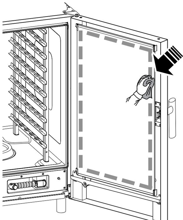
2. Avec la porte ouverte, appuyer sur les deux clips de fixation supérieur et inférieur, comme illustré, pour pouvoir passer la main entre la vitre intérieure et la vitre extérieure ;
