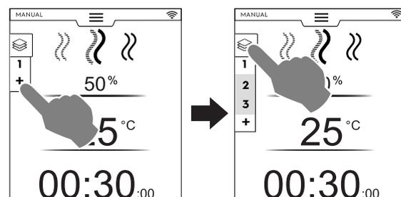
L'appareil ajoute des phases supplémentaires. Appuyer sur le tiroir Multiphase pour vérifier la liste des phases. Appuyer sur chaque ligne de phase pour attribuer de nouveaux paramètres.
