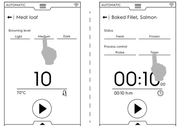
Certains pré-réglages sont entièrement automatiques. L'afficheur indique qu'aucun paramètre ne peut être réglé.
