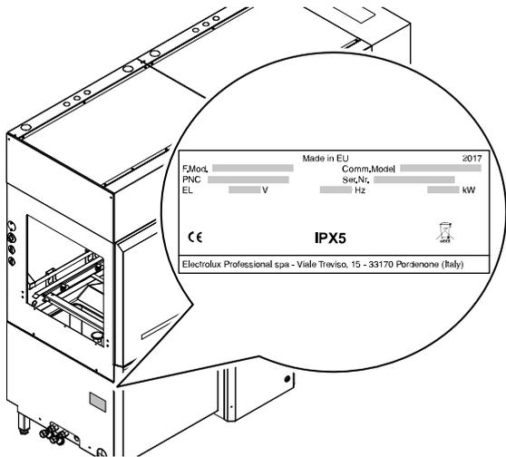
**Bild 1 Position des Typenschildes (rechts ausgerichtetes Gerät)**
