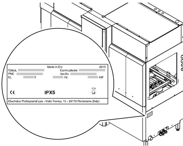
**Bild 2 Position des Typenschildes (links ausgerichtetes Gerät)**
