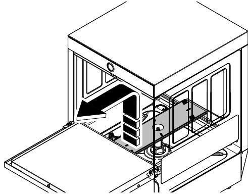
6. Uklonite odvodni filter „B“ i očistite sve ostatke hrane da biste sprječili začepljenje sustava za pražnjenje.
