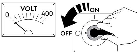
Prije provođenja bilo kakvog postupka instalacije, sklapanja, čišćenja ili održavanja, uređaj odvojite od izvora napajanja.
