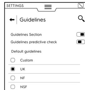
Mit der Funktion "Normprüfung-Vorhersage" können Sie dank des Endzeitpunkt-Schätzalgorithmus schon während des ersten Zyklusabschnitts eine Vorhersage über die Normprüfungsergebnisse erhalten.
