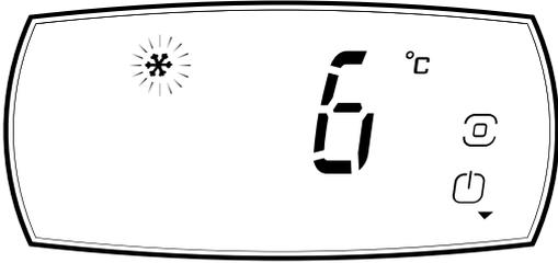
Zur Aktivierung bzw. Deaktivierung des Geräts 3 Sekunden lang auf die Programm-Schaltfläche drücken, um das Display zu entriegeln,
