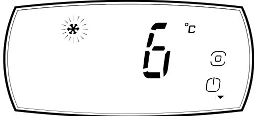
Zur Aktivierung bzw. Deaktivierung des Geräts 3 Sekunden lang auf die Programm-Schaltfläche drücken, um das Display zu entriegeln,
