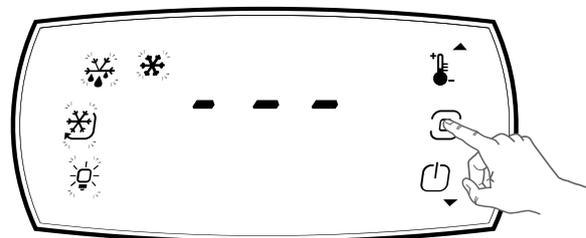
y, a continuación, toque la tecla de encendido/apagado
