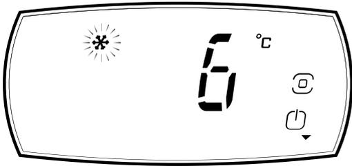
Pour activer et désactiver l'appareil, appuyer sur la touche Programme et la maintenir enfoncée 3 secondes pour déverrouiller l'afficheur
