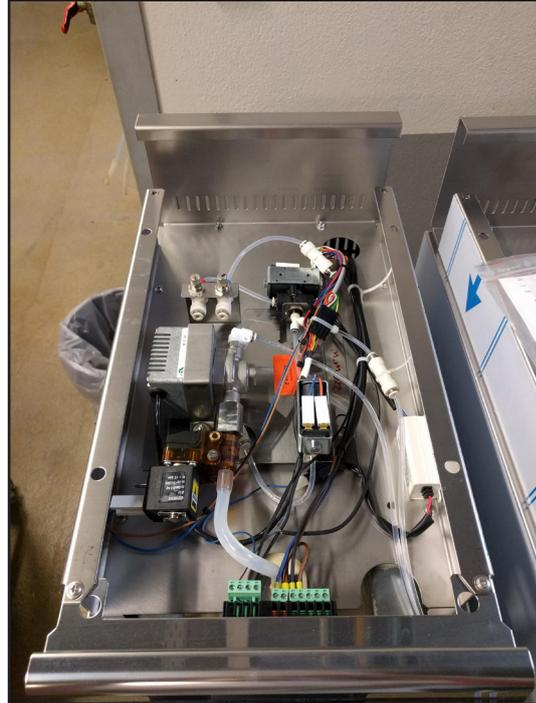
3- Débrancher le connecteur principal mâle au fond de la machine. Dévisser (pas entièrement) les deux vis, il suffit de glisser vers l'avant le bloc pour l'extraire du module
